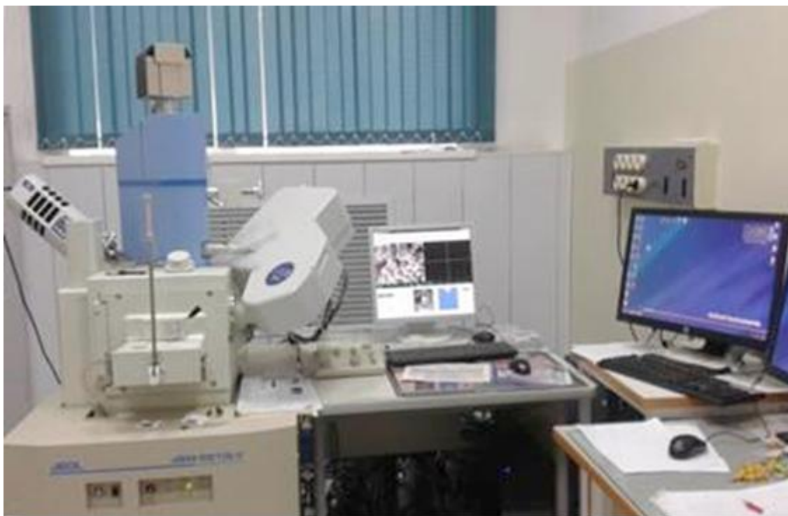
Рисунок 4. JSM-6610LV фирмы “JOEL” Растровый низковакуумный электронный микроскоп с термоэмиссионным катодом
